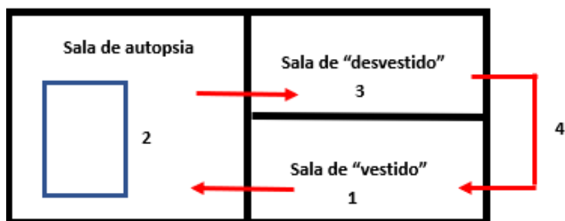
Figura 2: Disposición alternativa de los circuitos de limpio/sucio
